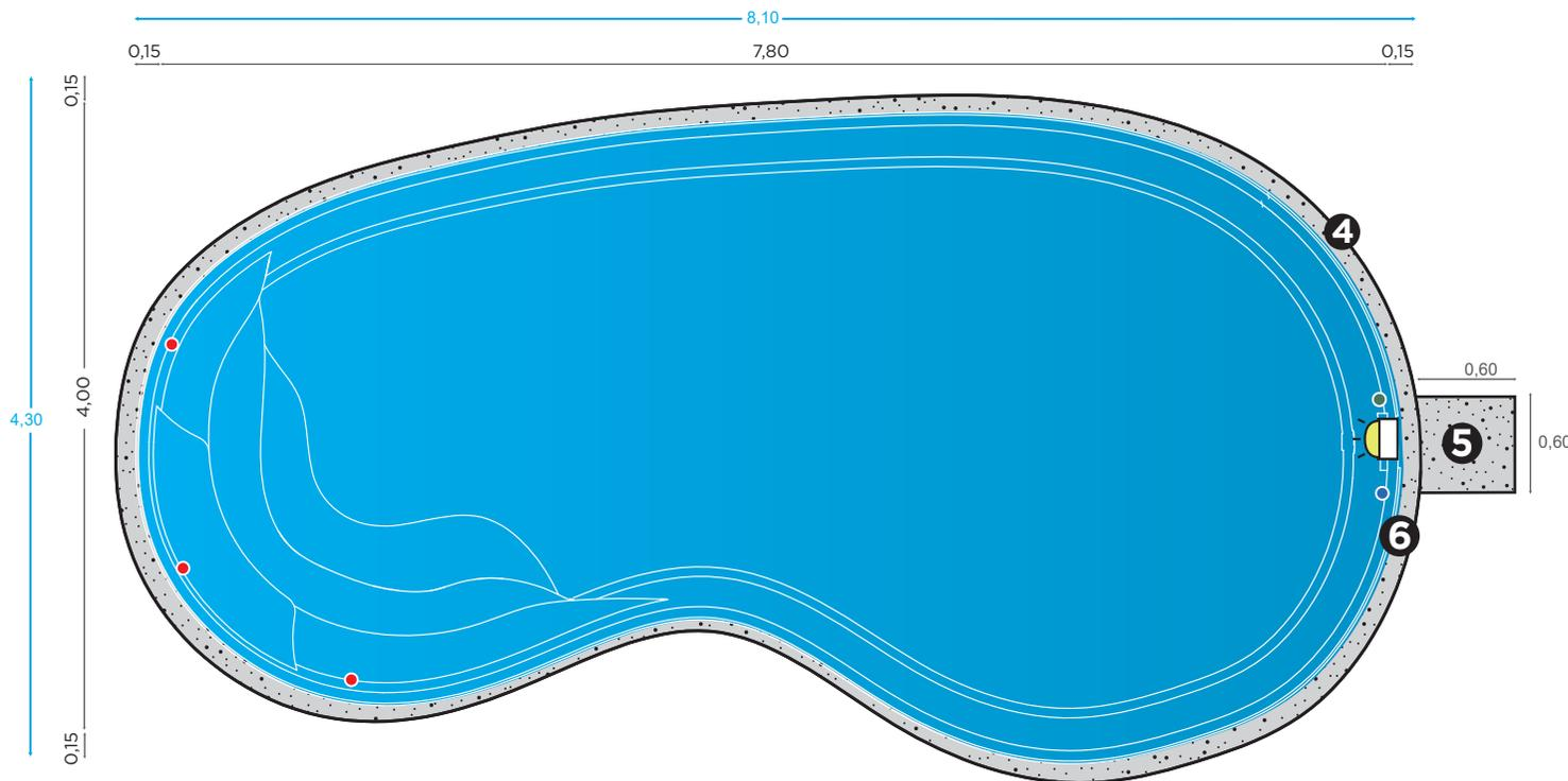
EN OPTION: gabarit en plastique avec la forme exacte de ce modèle pour faire l'implantation de la piscine sur le terrain et pouvoir effectuer le terrassement plus facilement.
